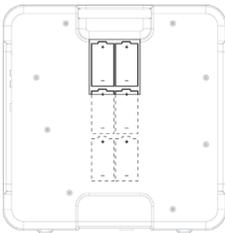
Mobile LP は単一乾電池 6 本（別売）で駆動させることができます。図のように電池の向きを合わせてセットしてください。
