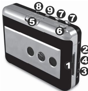
\* TAPE EXPRESS は、付属の USB ケーブルでコンピューターと接続することでコンピューターからの電源供給で駆動することができる他、市販の単三乾電池（2 個）で駆動させることができます。乾電池は本体のカバーを開いたところにある電池ボックスに入れます。
